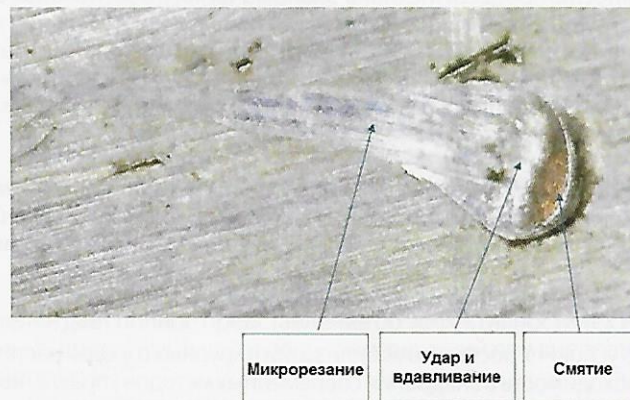
Рис. 7. Результат взаимодействия шипованной шины и дорожного покрытия.
