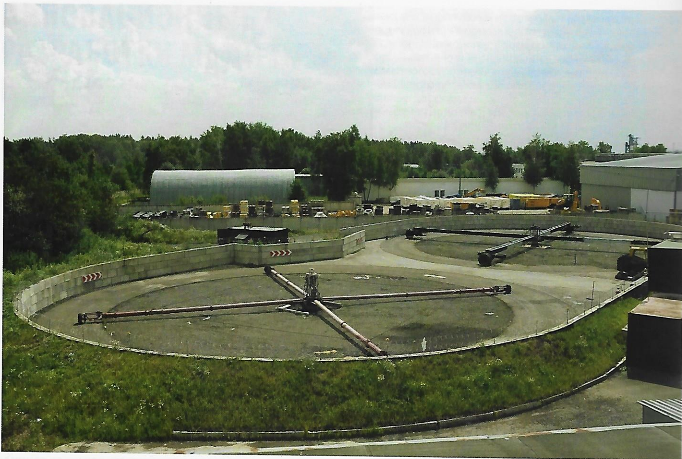
Рис. 5. Универсальный комплекс для испытания дорожных покрытий и автомобильных шин «Карусель»
