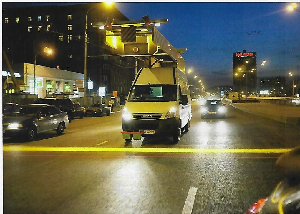
Рис. 4. Передвижная дорожная лаборатория «Автоматизированный дорожный сканер – АДС-МАДИ®» (модификации 2007 г.)
