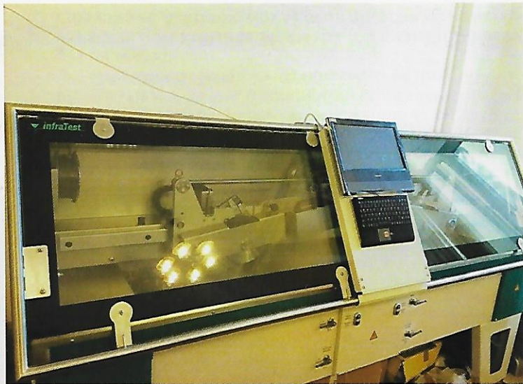
Рис. 3. Оборудование для испытания на колеобразование.
