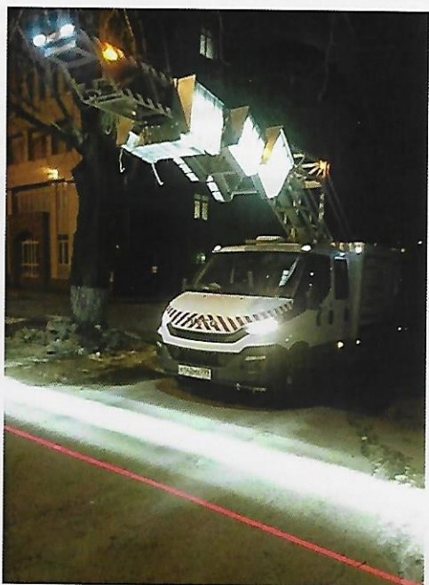
Рис. 6. Передвижная дорожная лаборатория «Автоматизированный дорожный сканер – АДС-МАДИ» (модификации 2018 г.)
